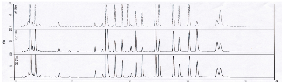
Şekil 1. Esterleşme işleminde standart katmalı örnek için elde edilen kromatogram
